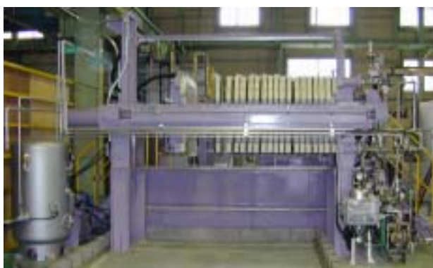
写真 4.11 脱水・イオン交換・洗浄装置
