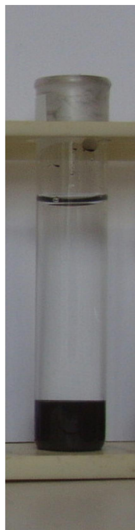
写真-3 Ca 型人工ゼオライト による凝集
