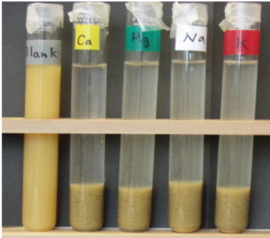
写真-1 人工ゼオライトによる鹿沼土を含む泥水の凝集 右から K、Na、Mg、Ca 型的人工ゼオライトを添加 左端：人工ゼオライトを加えていない泥水
